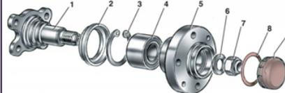
1 - цапфа; 2 - фрезашитное кольцо; 3 - стопорное кольцо; 4 - ступицный подшипник; 5 - ступица колеса; 6 - шайба подшипника; 7 - гайка ступицы; 8 - уплотнительное кольцо; 9 - колпак ступицы
